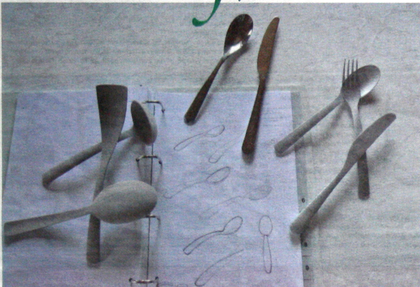
Nyt bestik skridt for skridt. Først en håndskitse, så en todimensionel computertegning, dernæst håndformes det i træ, sprayes med sølv (th i billedet), hvorefter det måles op og alle data puttes i computeren, der laver en tredimensionel arbejdstegning. Endelig det færdige resultat (øverst).
